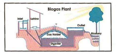
Fig: 27.17 Biogas Production plant.
