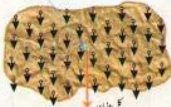
شکل 4.20: کسی جسم کا سنٹرائف گریویتی ایک ایسا پوائنٹ ہوتا ہے جہاں اس کا تمام وزن عموداً نیچے کی جانب عمل کرتا ہوا محسوس ہوتا ہے۔
