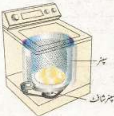
شکل 3.30: واشنگ مشین کے ڈرائیئر کی دیواریں سوراخ دار ہوتی ہیں۔
