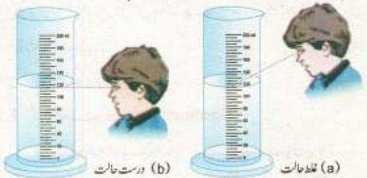
شکل 1.19 (a) آنکھ مائع کی سطح سے ہتھ ہونے پر مائع کا والیوم نوٹ کرنے کا غلط طریقہ۔ (b) آنکھ مائع کی سطح کے مساوی رکھ کر مائع کا والیوم نوٹ کرنے کا درست طریقہ۔
