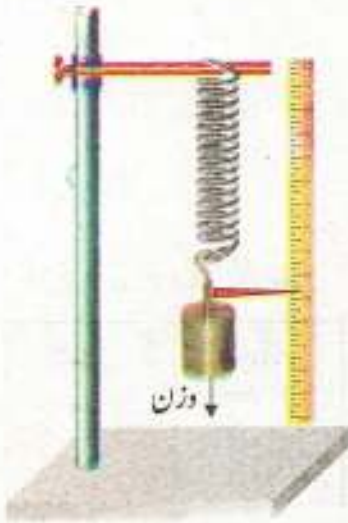
شکل 7.23: ہر گھ کی لمبائی میں اضافے کا انحصار وزن پر ہوتا ہے۔
