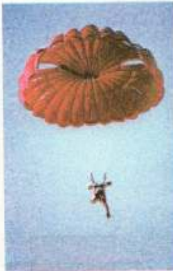
شکل 4.28: ایک چھانڈ بردار یونیفارم ولاسٹی سے نیچے پڑتا ہے۔ اس لیے وہ ایکوی لبریم میں ہے۔
