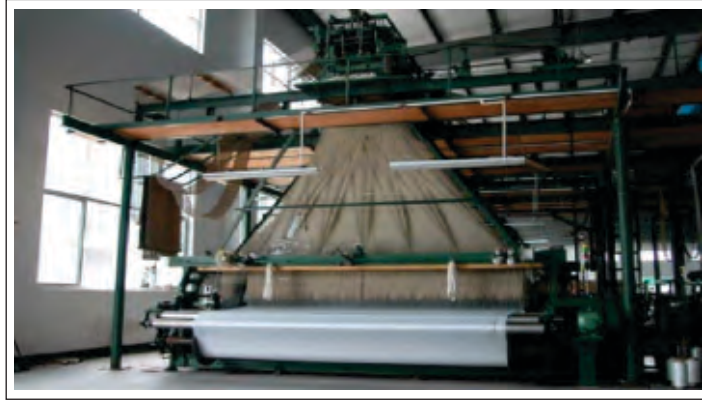
دور حاضر کی جدید ترین جیکارڈ مشین پر کپڑا بنانے کا عمل
